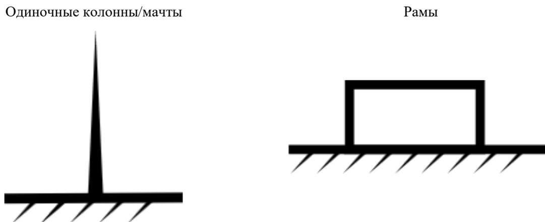
*Рисунок 6.1 – Схемы опор ЗОК*
