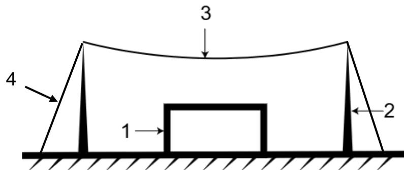
1 – защищаемый объект; 2 – независимая опорная конструкция; 3 – защитная сетка;
