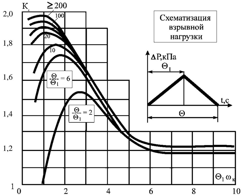
Рисунок 7.1 – График для определения коэффициента динамичности  $K_d$
